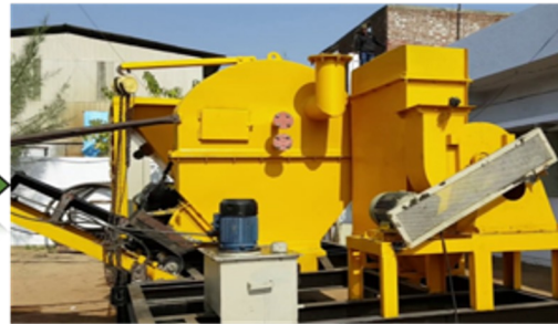
3. Mini Hot Mix Plant
